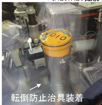
グローブボックス搬入後の 貯蔵容器の保管状況
